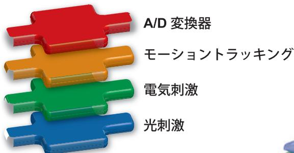
専用のヘッドステージはモジュール式になっており、研究者の目的に合わせてカスタマイズすることができます。基本は A/D 変換器内蔵型のヘッドステージですが、ご要望に合わせて、電気または光刺激、モーションセンサーなどのモジュールを搭載することが可能です。
