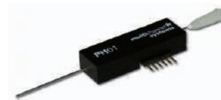
TCx シリーズの温度コントローラと組み合わせて使用できるヒータングカニューラです。灌流液の温度を調製したい場合はお勧めです。
