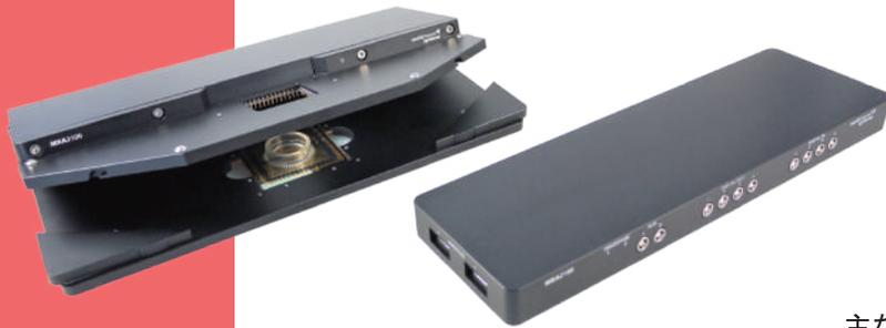
Multichannel systems 社の MEA2100 シリーズの廉価タイプです。拡張性やアンプ性能に制限がありますが、神経・心筋細胞の電位を取得するのに十分なスペックを有しています。
