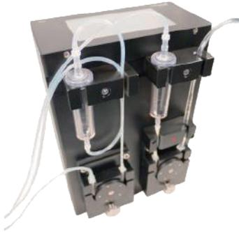
In vitro MEA システムで使用するペリスタポンプです。完全な独立制御でペリスタポンプ単体で動作します。そのため、MEA 実験に使用されるのはもちろん、その他実験系にもご活用いただけます。また PPS2 は電気生理向けに開発されているため、ペリスタポンプ特有の脈流が少ないのが特徴です。フローによるノイズを最低限に抑えるよう設計されています。
