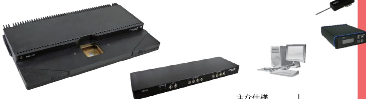
MEA2100 のヘッドステージ性能はそのままにさらに多チャンネル記録に特化した 256 システムです。電極が増えたことで測定できるエリアを広範囲にカバーすることができます。また 256 システムにしかない 9 ウェルタイプの電極はスクリーニングにも最適です。
